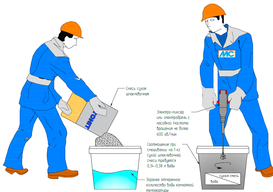
Рис. 29. Организация работ по затворению сухой шпаклевочной смеси
